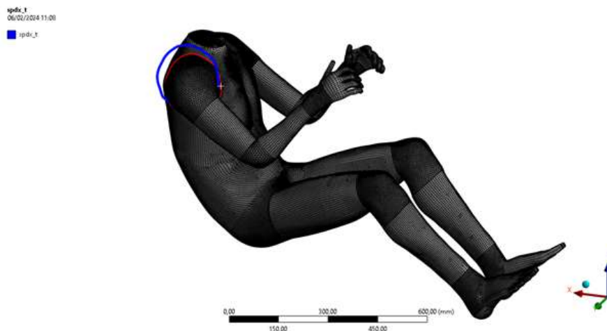
Figura 6.8: Preview del campo di spostamenti alle RBF per spalla-busto destra
