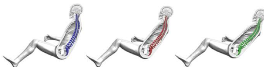
Figura 2.2: Inclinazioni dello schienale implementate in THUMS Version7. Da sinistra verso destra: angolo di inclinazione di 25 deg, 35 deg e 45 deg
