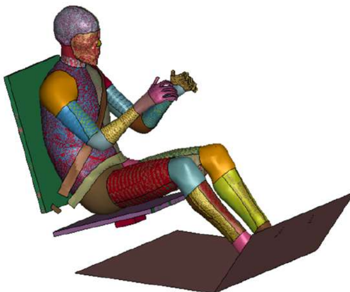
Figura 8.1: Posizionamento di THUMS all'istante iniziale di simulazione nel frontal sled test
