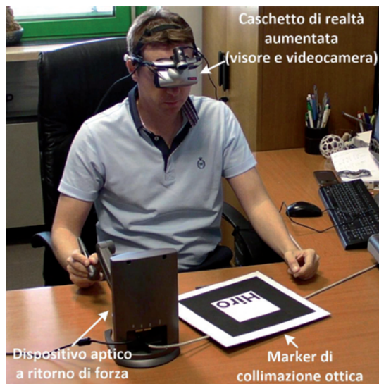
Figura 2 - L'implementazione del sistema in realtà aumentata con il dispositivo a ritorno di forza.
