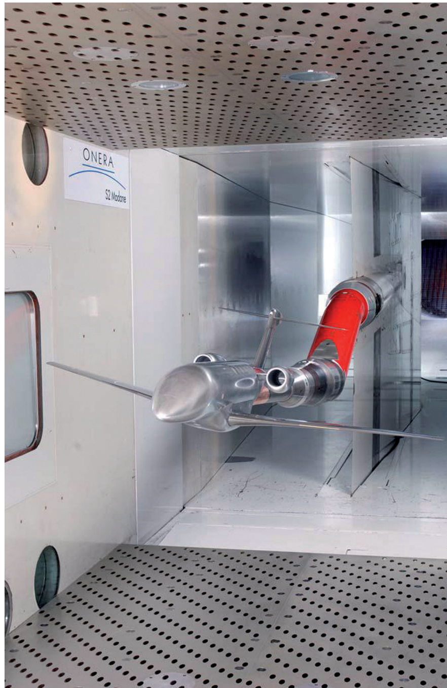
Fig. 2 - Dettaglio dell'installazione del modello di galleria del velivolo Piaggio
