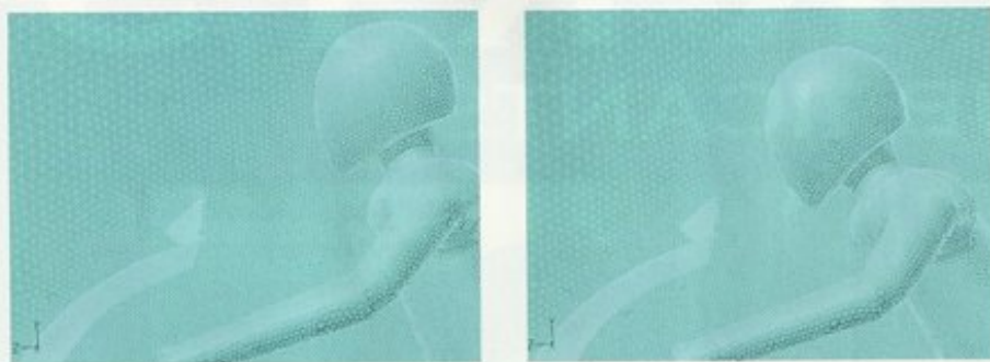
Figura 9: La mesh viene deformata per cambiare l'inclinazione del pilota di 15 gradi.
