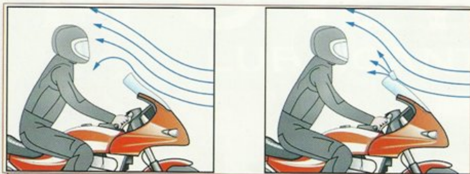
● Figura 2: Principio di funzionamento del Variotouring (destra). Il flusso d'aria viene diviso grazie alla presenza del canale compreso fra il cupolino e il deflettore che consente di ottenere delle condizioni di flusso ottimizzate attorno al casco.
