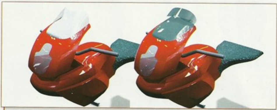
● Figura 3: Modello CAD della moto con il cupolino originale (sinistra) e con il Variotouring (destra).
