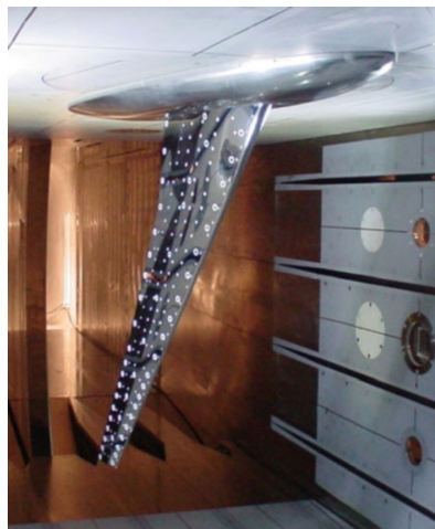
Figura 5.1: Modello HIRENASD in galleria del vento
