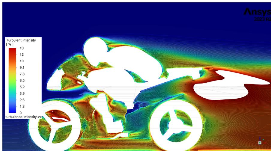
Figura 45: *Contour delle turbolenze del modello modificato con l'ottimizzazione 5.2.*
