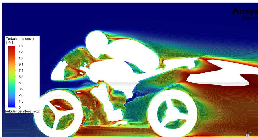
Figura 29: *Contour delle turbolenze del modello modificato con l'ottimizzazione 3.2.*
