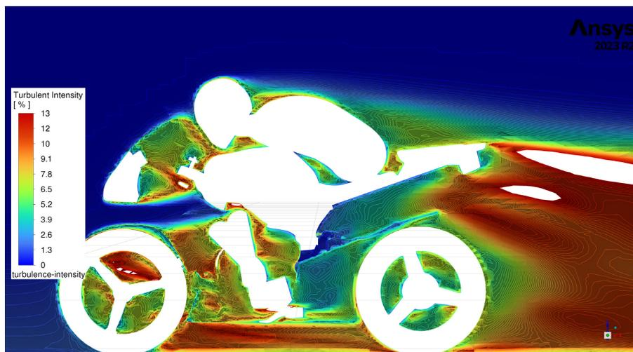
Figura 13: *Contour delle turbolenze del modello modificato con la prima ottimizzazione.*
