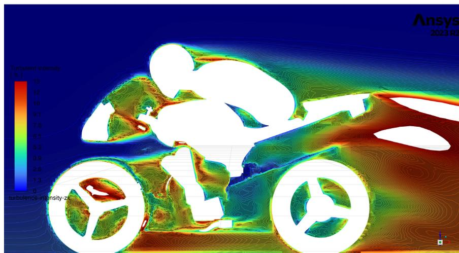
Figura 41: *Contour delle turbolenze del modello modificato con l'ottimizzazione 5.1.*
