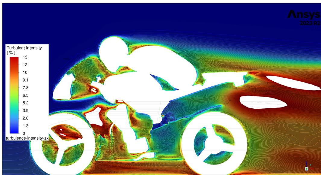
Figura 49: *Contour delle turbolenze nel modello Multi-5.*
