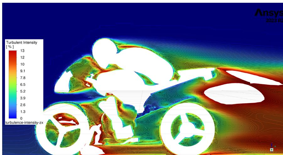
Figura 25: *Contour delle turbolenze del modello modificato con l'ottimizzazione 3.1.*
