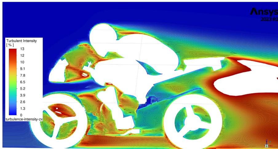
Figura 40: *Contour delle turbolenze nel modello iniziale.*
