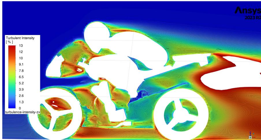
Figura 44: *Contour delle turbolenze nel modello iniziale.*
