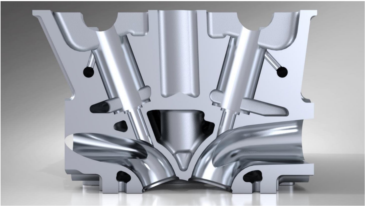
Figura 4. Sezione della testata soggetta a morphing
