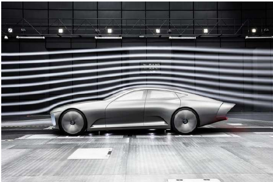
Figura 3.6: Galleria del vento per il calcolo della aerodinamica con particolare sulle linee di flusso
