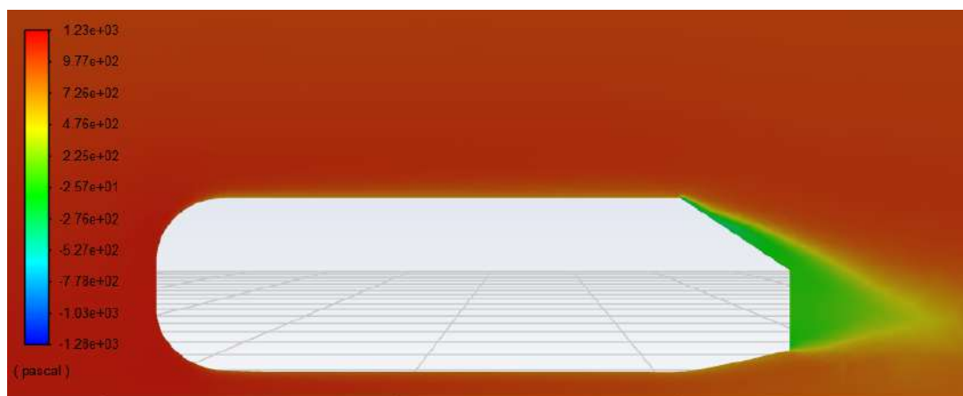
Figura 8.93: Andamento della pressione totale valutate sul piano di simmetria della geometria ottimizzata tramite AP
