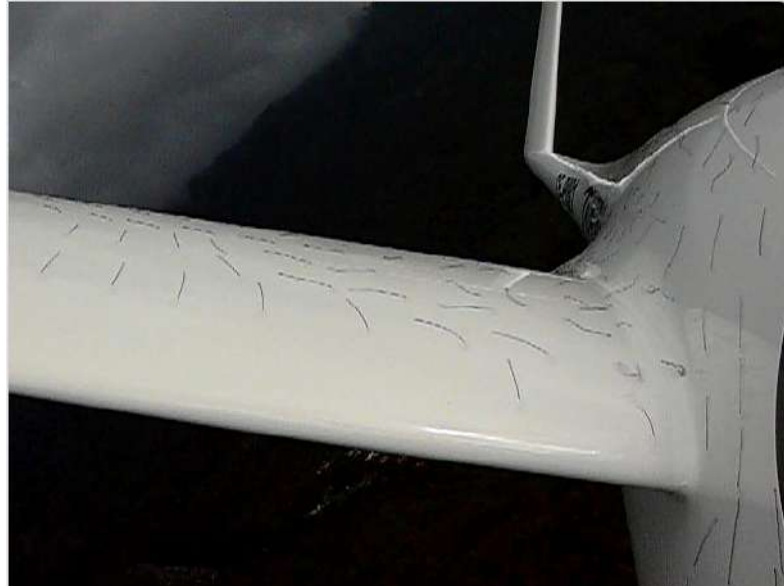
Figura 10: visualizzazione della separazione dello strato limite mediante fili di lana
